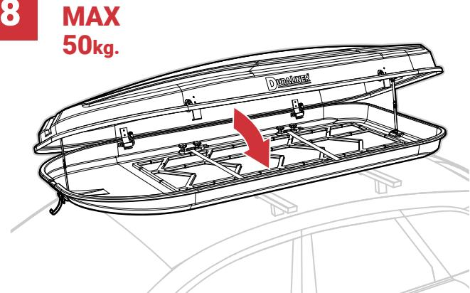
Répartir uniformément les bagages et le matériel à l'intérieur du coffre de toit. Abaisser le couvercle. Insérer les clés dans la serrure tourner horizontalement et retirer les clés. Fixer le loquet avant et arrière.
