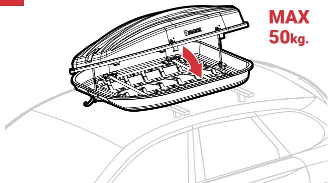
Repartir uniformément les bagages et le matériel à l'intérieur du coffre de toit. Abaisser le couvercle. Insérer les clés dans la serrure, tourner horizontalement et retirer les clés. Fixer le loquet avant.
