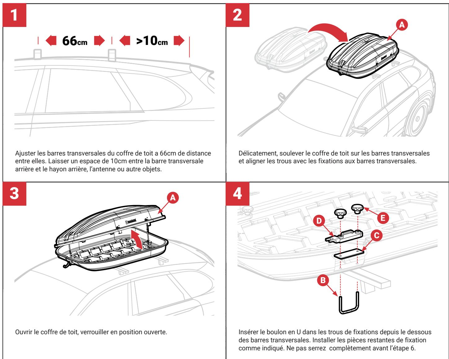
Ajuster les barres transversales du coffre de toit à 66cm de distance entre elles. Laisser un espace de 10cm entre la barre transversale arrière et le hayon arrière, l'antenne ou autre objets.
