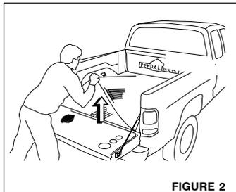
**PRUDENCE :** Il est conseillé à deux (2) personnes d'installer la doublure du plateau afin d'éviter des dégâts à la surface peinte du pick-up.
